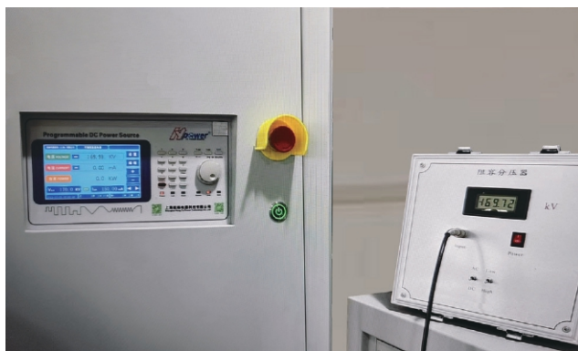
170kV电压精度现场实测图
